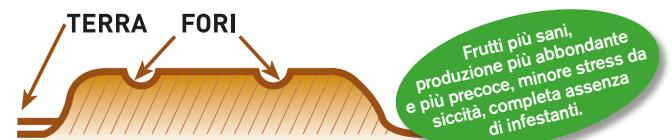
Stendere il foglio sul terreno prima della semina o del trapianto (come nel disegno di cui sopra). Completamente impermeabile. La foratura del telo va effettuata sul posto eseguendo due tagli in croce con un coltello affilato. **Foglio in polietilene nero**, non forato, spessore mm. 0,005.
