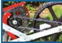
La cinghia collegata alla ruota anteriore trasmette il movimento di rotazione al dischetto. Con un semplice gesto di rotazione si sostituiscono i dischetti di semina
