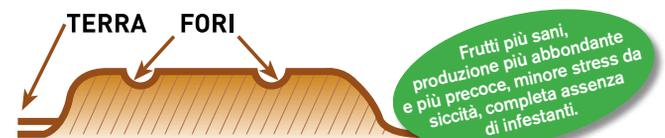
Stendere il foglio sul terreno prima della semina o del trapianto (come nel disegno di cui sopra). Completamente impermeabile. La foratura del telo va effettuata sul posto eseguendo due tagli in croce con un coltello affilato.
